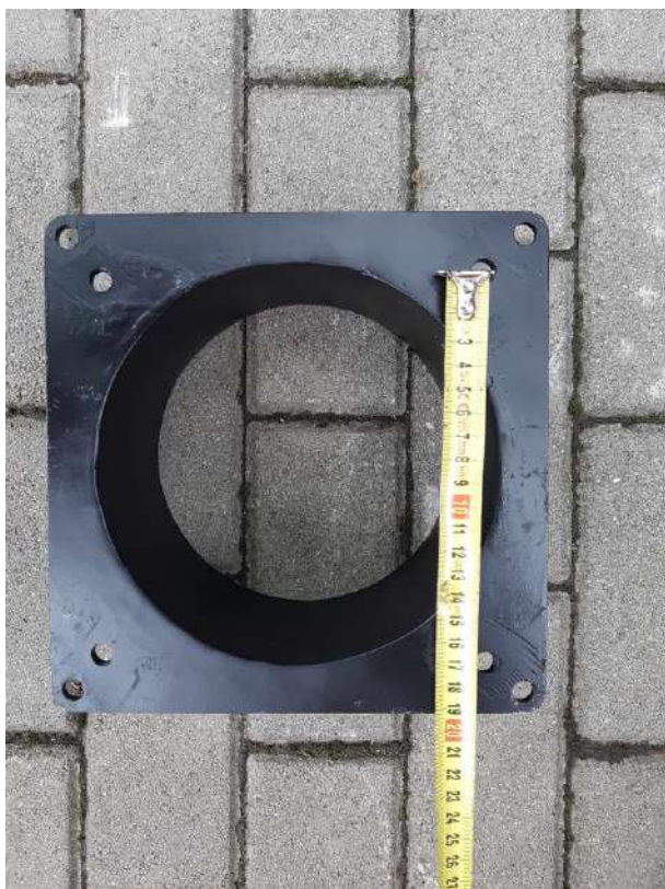
13. Kép – Az általunk gyártatott és használt égőfej közdarab mérete_3
