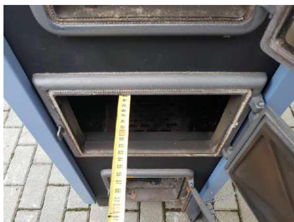
4. Kép – Fontos az adott kazán tűzterének mélysége, ajánlott min. 450 mm
