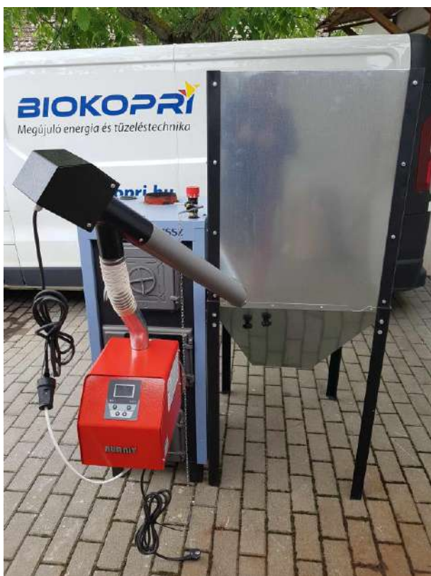
41-42. Kép – A kész pellet kazán rendszer
