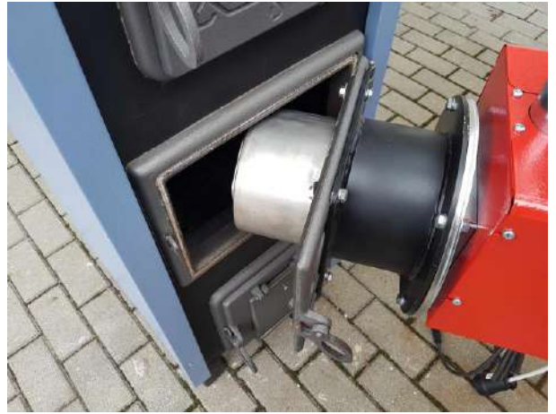
35. Kép – Ellenőrizzük, hogy az ajtó nyitása közben az égőfej ne akadjon meg a kazán oldalában, illetve az ajtó szélében
