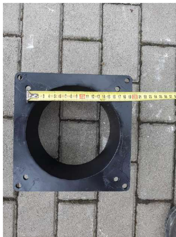
12. Kép – Az általunk gyártatott és használt égőfej közdarab mérete_2
