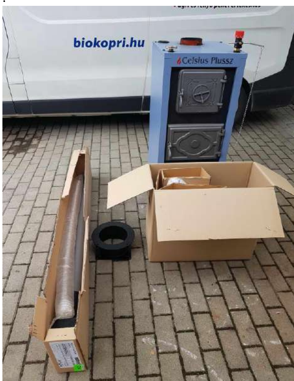
8. Kép – Félig kicsomagolva, a kitérő csiga és az égőfej között használt gravitációs ejtőcső a csiga dobozában szállított
