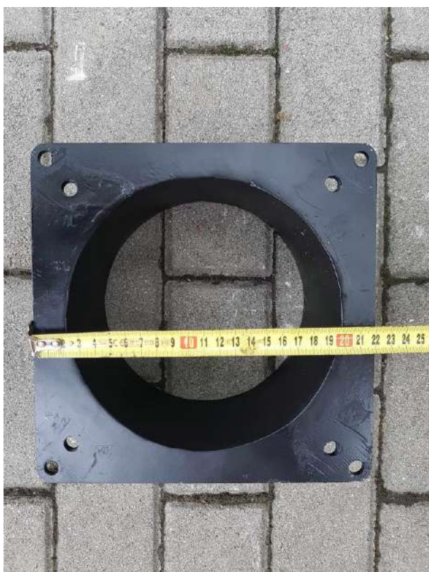
15. Kép – Az általunk gyártatott és használt égőfej közdarab mérete_5
