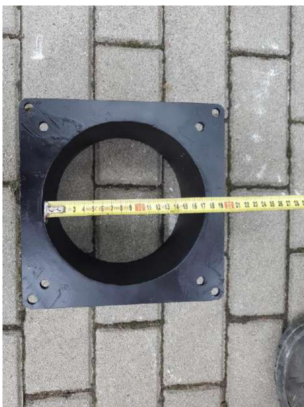
11. Kép – Az általunk gyártatott és használt égőfej közdarab mérete_1
