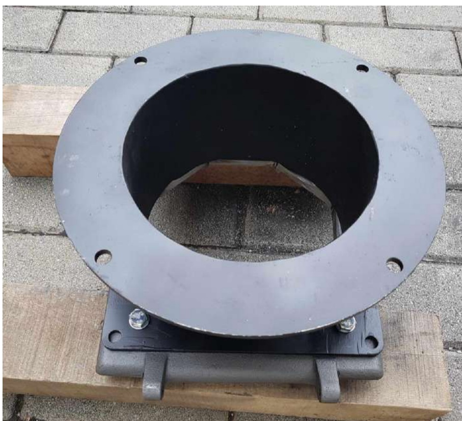
27. Kép – Közdarab felcsavarozva a kazán ajtóra
