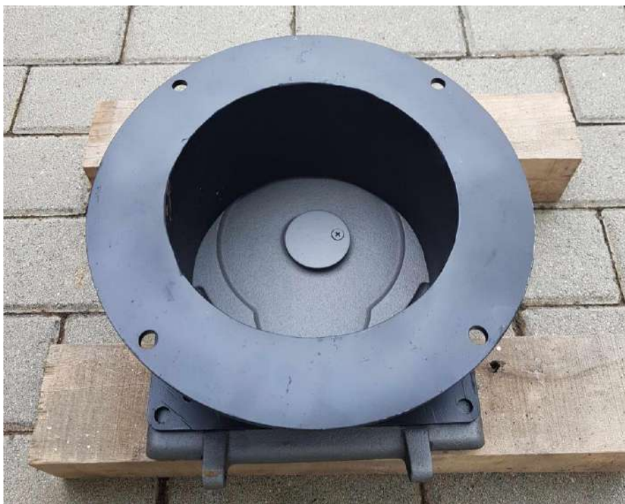
18. Kép – Égőfej közdarab beigazítása a végső helyére
