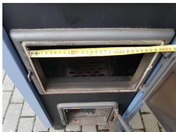
5. Kép – Fontos az égőfej felszerelhetőségéhez az ajtónyílás szélessége, ajánlott min. 250 mm
