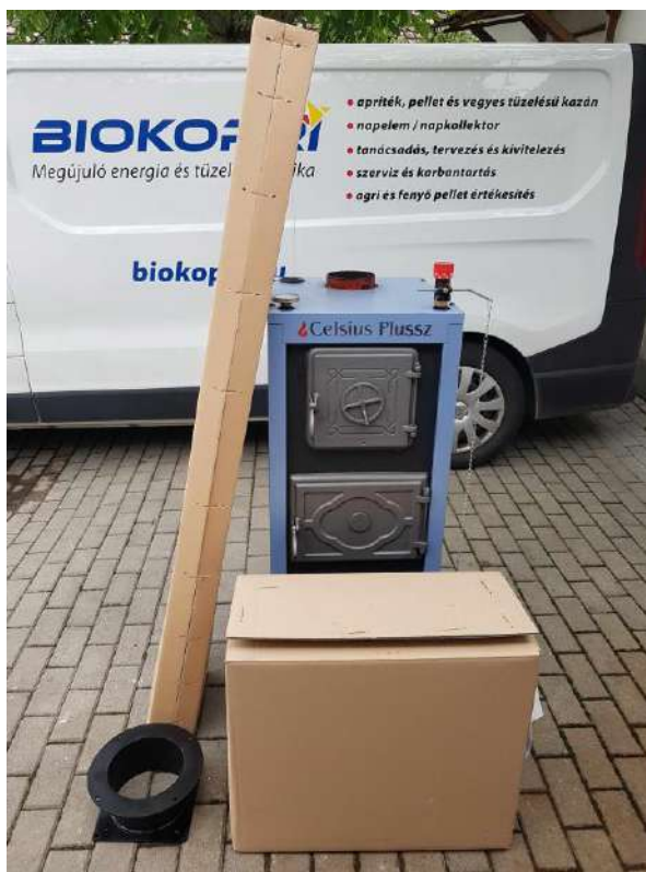
7. Kép – Az égőfej és a pellet kitérő csiga doboza, illetve a külön szállított közdarab, mely az égőfej és a kazán ajtó közé kerül felszerelésre.
